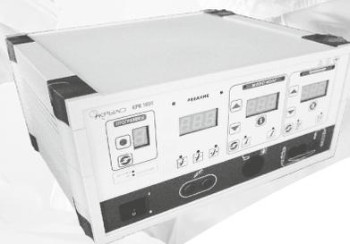
Аппарат ЭХВЧ КРК 1001 предназначен для рассечения и коагуляции биологических тканей.
